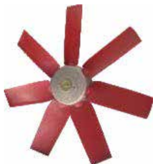
W XD (800 y 1000 mm), Hélice de material termo plástico reforzado con Fibra de vidrio. El cuál es material anti-chispa y resistente a la corrosión, comúnmente utilizado para aplicaciones de altas velocidades con ayuda de su peso reducido. Ésta hélice cuenta con un corazón de aluminio inyectado y álabes de ángulo variable.
