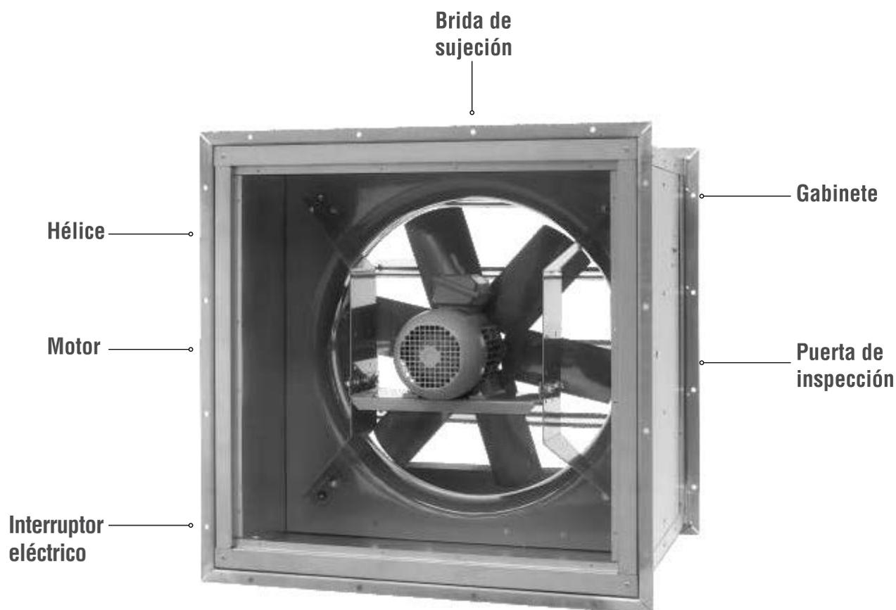
Hélices aerodinámicas, fabricadas en acero al carbón, aluminio inyectado y termoplástico reforzado con fibra de vidrio pintado con pintura en polvo poliéster electrostático, acabado estándar.
