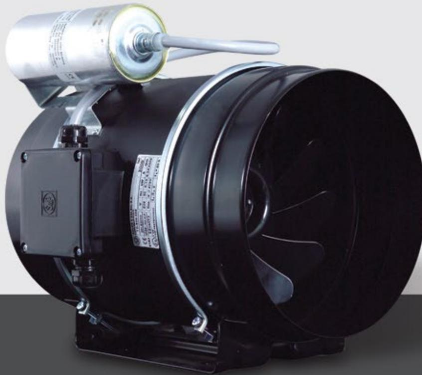
Ventiladores helicocentrífugos in-line de bajo perfil, especialmente diseñados para la extracción de aire en atmósferas explosivas, fabricados en chapa de acero protegida contra la corrosión con pintura poliéster negra (excepto el modelo TD-800/200, que está fabricado en material plástico tratado para evitar la retención de electricidad estática), cuerpo-motor desmontable sin necesidad de tocar los conductos.
