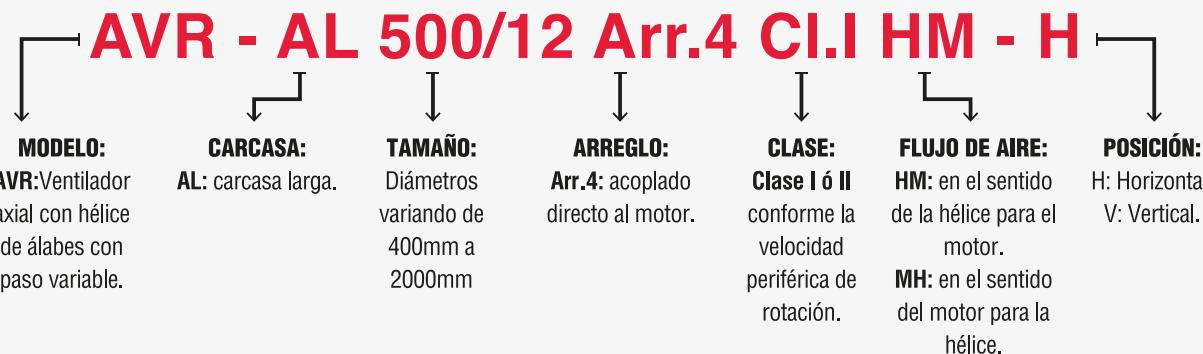
**Observación:** En las condiciones HM, el ventilador debe tener un cono o un conducto de largo, por lo menos, dos veces su diámetro, en la aspiración, de forma que alcance las características definidas en las curvas y tablas.
