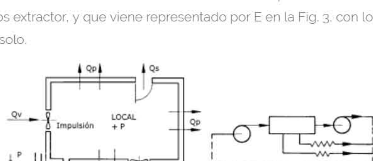
Fig. 3. Local con exfiltraciones
