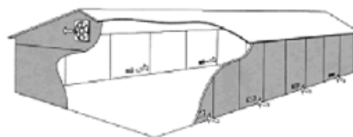
Figura 12. Nave en depresión
