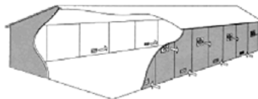
Figura 10. Nave en depresión
