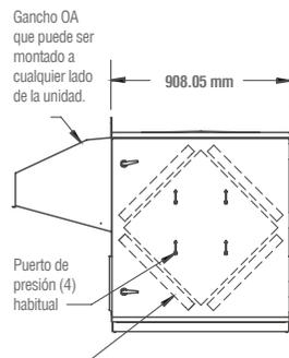
**Nota:** contiene filtros de 20" x 20" x 2" plegados desechables provistos para la instalación y que se pueden intercambiar dependiendo de los requerimientos de su flujo de aire. Los filtros deben ser montados de manera ascendente hacia el centro en dirección de la unidad de ingreso de flujo de aire.
