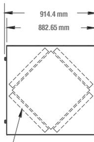
**Nota:** contiene filtros de 20" x 20" x 2" plegados desechables provistos para la instalación y que se pueden intercambiar dependiendo de los requerimientos de su flujo de aire. Los filtros deben ser montados de manera ascendente hacia el centro en dirección de la unidad de ingreso de flujo de aire.
