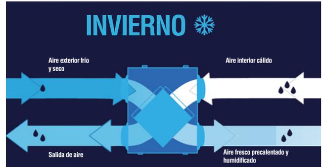
EN INVIERNO, EL AIRE FRÍO Y SECO DEL EXTERIOR ES PRECALENTADO Y HUMIDIFICADO GRACIAS AL AIRE INTERIOR CÁLIDO QUE SALE.
