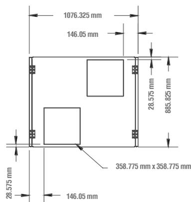
**Nota:** contiene filtros de 20" x 20" x 2" plegados desechables provistos para la instalación y que se pueden intercambiar dependiendo de los requerimientos de su flujo de aire. Los filtros deben ser montados de manera ascendente hacia el centro en dirección de la unidad de ingreso de flujo de aire.
