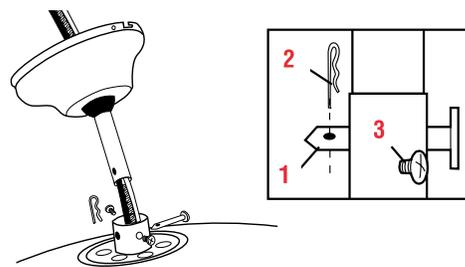
Pasar los conductores del motor a través del ensamblaje de la barra/cubierta de control electrónico e insertar la barra hacia abajo en el acople del barral. Instale el perno (1) a través del acople y la barra. Inserte la chaveta de sujeción (2) en el perno hasta que encaje en su lugar. Apriete los tornillos (3) en el acople.
